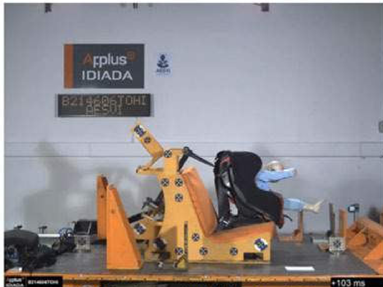
Picture 3: Máximo desplazamiento X / X maximum displacement
