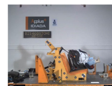
Picture 11: Máximo desplazamiento X / X maximum displacement
