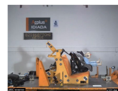
Picture 7: Máximo desplazamiento X / X maximum displacement
