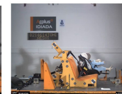
Picture 35: Máximo desplazamiento X / X maximum displacement
