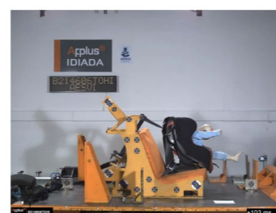
Picture 3: Máximo desplazamiento X / X maximum displacement
