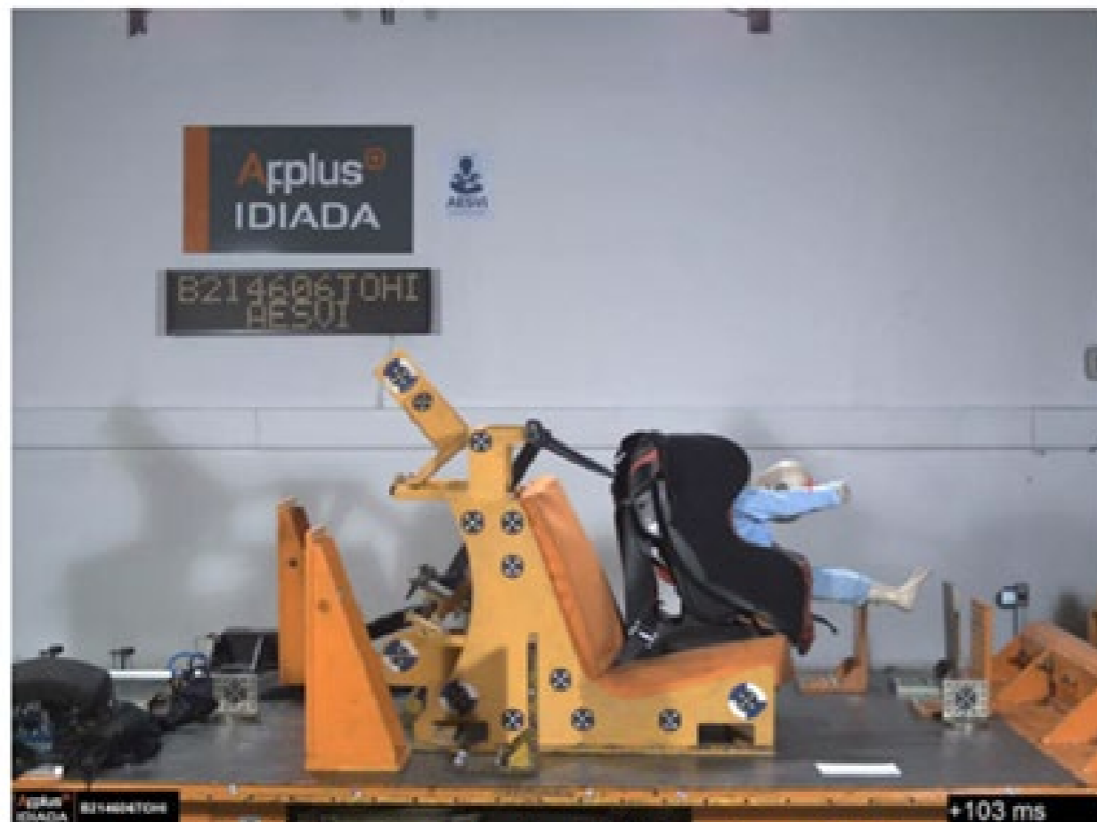
Picture 3: Máximo desplazamiento X / X maximum displacement
