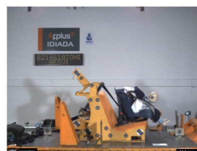
Picture 19: Máximo desplazamiento X / X maximum displacement
